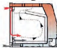
δευτερογενής αέρας / αεροκουρτίνα
