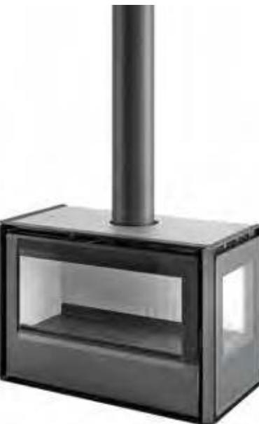
**IT** Inserto in acciaio angolare, finitura nera, vetro serigrafato, interno in Caloristone bianco. Apertura porta ad anta. Uscita fumi Ø 150mm. Kit ventilazione di serie. Possibilità di adattare una cornice nera standard di 4,5 cm o una cornice nera decorativa di 9 cm.
