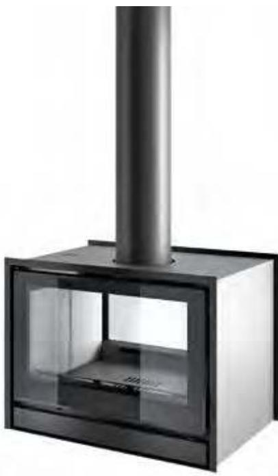
**IT** Inserto in acciaio bifacciale, finitura nera, vetro serigrafato, interno in Caloristone bianco, aria comburente raccordabile all'esterno. Apertura porta ad anta su entrambi i lati. Uscita fumi Ø 200mm. Kit ventilazione opzionale. Possibilità di adattare una cornice nera standard di 4,5 cm o una cornice nera decorativa di 9 cm.
