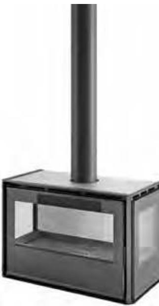
**IT** Inserto in acciaio trifacciale, finitura nera, vetro serigrafato, interno in Caloristone bianco. Apertura porta ad anta. Uscita fumi Ø 150mm. Kit ventilazione di serie. Possibilità di adattare una cornice nera standard di 4,5 cm o una cornice nera decorativa di 9 cm.
