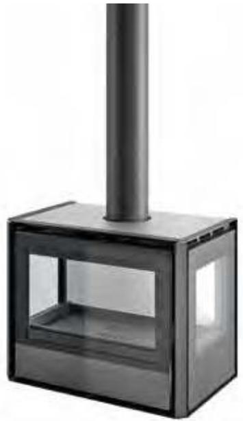
**IT** Inserto in acciaio trifacciale, finitura nera, vetro serigrafato, interno in Caloristone bianco. Apertura porta ad anta. Uscita fumi Ø 150mm. Kit ventilazione di serie. Possibilità di adattare una cornice nera standard di 4,5 cm o una cornice nera decorativa di 9 cm.
