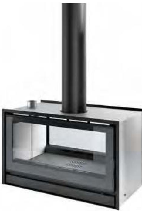
**IT** Inserto in acciaio bifacciale, finitura nera, vetro serigrafato, interno in Caloristone bianco, aria comburente raccordabile all'esterno. Apertura porta ad anta su entrambi i lati. Uscita fumi Ø 200mm. Kit ventilazione opzionale. Possibilità di adattare una cornice nera standard di 4,5 cm o una cornice nera decorativa di 9 cm.
