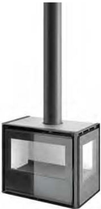
**IT** Inserto in acciaio angolare, finitura nera, vetro serigrafato, interno in Caloristone bianco. Apertura porta ad anta. Uscita fumi Ø 150mm. Kit ventilazione di serie. Possibilità di adattare una cornice nera standard di 4,5 cm o una cornice nera decorativa di 9 cm.
