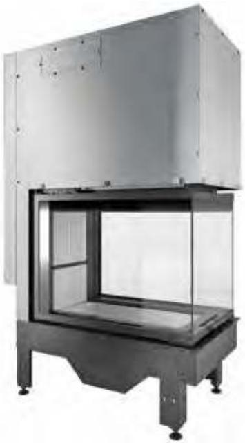
**IT** Focolare in Caloristone bianco, porta a saliscendi a tre vetri serigrafati con apertura ad anta per la pulizia e montante inferiore in acciaio per una maggiore stabilità nel tempo. Camera combustione ermetica e aria comburente raccordabile all'esterno. Maniglia e mano fredda di serie. Uscita fumi da Ø 200mm. Ventilazione forzata canalizzabile fino a 8m (opzionale).
