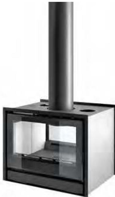
**IT** Inserto in acciaio bifacciale, finitura nera, vetro serigrafato, interno in Caloristone bianco, aria comburente raccordabile all'esterno. Apertura porta ad anta su entrambi i lati. Uscita fumi Ø 200mm. Kit ventilazione opzionale. Possibilità di adattare una cornice nera standard di 4,5 cm o una cornice nera decorative di 9 cm.
