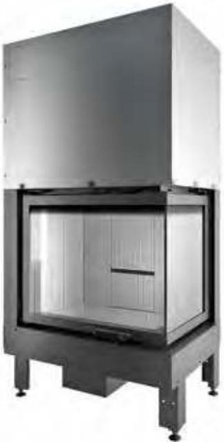
**IT** Focolare in Caloristone bianco, porta a saliscendi a due vetri serigrafati con apertura adanta per la pulizia e montante inferiore in acciaio per una maggiore stabilità nel tempo. Camera combustione ermetica e aria comburente raccordabile all'esterno. Maniglia e mano fredda di serie. Uscita fumi da Ø 200mm. Ventilazione forzata canalizzabile fino a 8m (opzionale).
