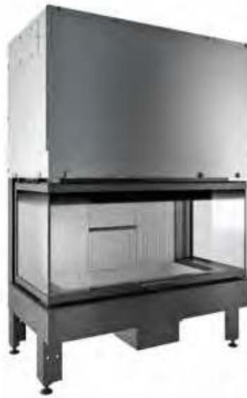
**IT** Focolare in Caloristone bianco, porta a saliscendi a tre vetri serigrafati con apertura ad anta per la pulizia e montante inferiore in acciaio per una maggiore stabilità nel tempo. Camera combustione ermetica e aria comburente raccordabile all'esterno. Maniglia e mano fredda di serie. Uscita fumi da Ø 200mm. Ventilazione forzata canalizzabile fino a 8m (opzionale).
