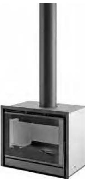
**IT** Inserto in acciaio, finitura nera, vetro serigrafato, interno in Caloristone bianco, aria comburente raccordabile all'esterno. Apertura porta ad anta. Uscita fumi ø 150mm. Kit ventilazione opzionale. Possibilità di adattare una cornice nera standard di 4,5 cm o una cornice nera decorativa di 9 cm.
